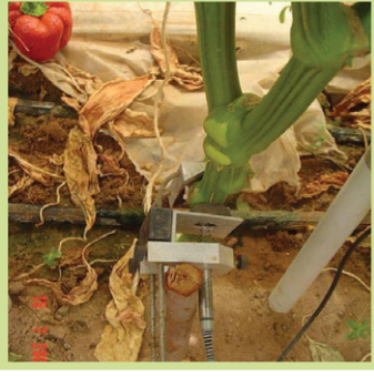
شكل 21: آلة قياس تغيرات جذع شجرة البرتقال (اليسار) و ساق الفلفل (اليمن)
